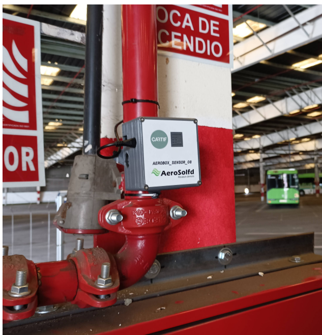
Sensores de partículas en el hangar de Auvasa (primera y segunda foto) y un registrador de señales incorporado en un autobús.
