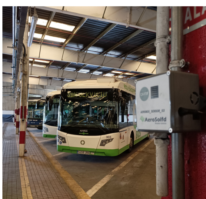
Sensores de partículas en el hangar de Auvasa (primera y segunda foto) y un registrador de señales incorporado en un autobús.
