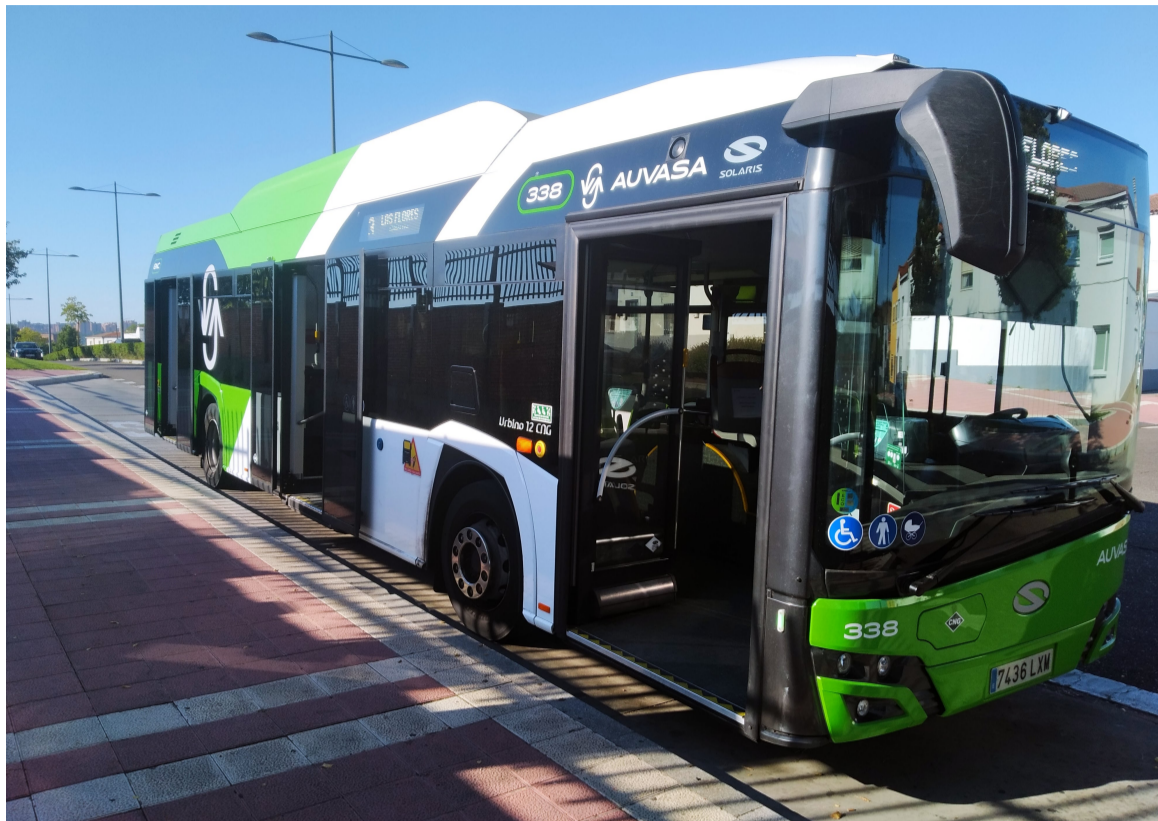
Uno de los autobuses de Auvasa sensorizado por CARTIF para registrar la emisión de partículas.
